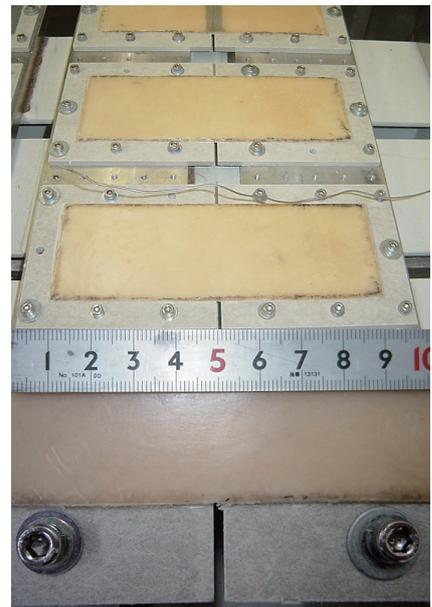
◆ JASS 8 疲労試験 各試験温度下で各ムーブメントを 500 サイクル繰り返し
